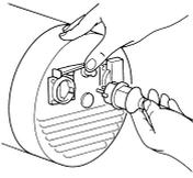
Per il collegamento a terra è prevista anche la possibilità di utilizzare un foro presente sul coperchio posteriore, che è accessibile senza dover smontare la cuffia.
