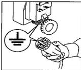
Per il collegamento terra è prevista anche la possibilità di utilizzare un foro presente sul coperchio posteriore, che è accessibile senza dover smontare la cuffia.
