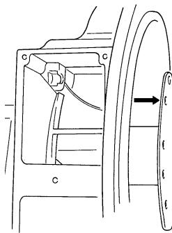
d) avvicinare l'alternatore al motore di accoppiamento
