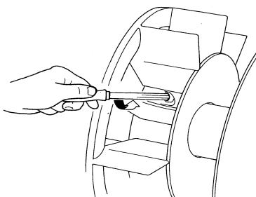
c) posizionare uno dei fori dei dischi in prossimità della parte alta di una delle aperture laterali e posizionare lo scarico realizzato su una delle pale della ventola, nella stessa posizione.
