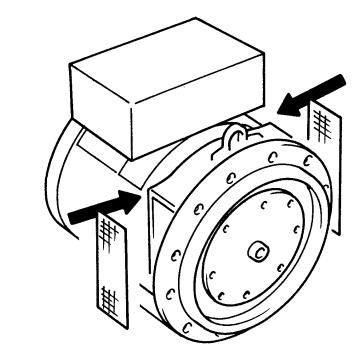
i) montare le due retine laterali di protezione, fornite a corredo del generatore.
