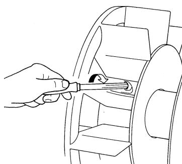
h) terminata l'operazione di bloccaggio dischi, ribloccare la ventola serrando la relativa vite con una coppia di serraggio pari a  $12 \text{ Nm} \pm 10\%$ ; la posizione radiale della ventola non è vincolante per il corretto funzionamento del sistema
