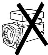
I generatori sviluppano calore anche elevato in funzione della potenza generata. Pertanto non toccare il generatore se non con guanti antiscottatura e attendere, una volta spento, che esso raggiunga la temperatura ambiente.
