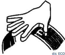
Nelle fasi di montaggio e smontaggio della rete, assicurarsi di tenere in posizione con le mani la stessa per evitare che l'elasticità della rete possa colpire l'operatore o chi è nelle vicinanze.
