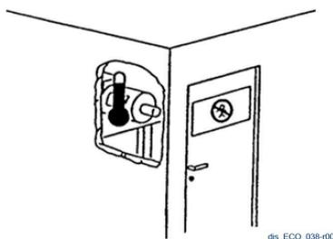
**i** Installare l'alternatore in ambiente aerato. Un'aerazione insufficiente può causare surriscaldamento e malfunzionamento dell'alternatore.
