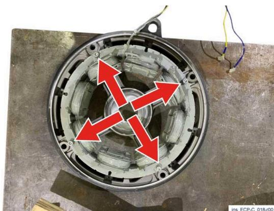
1) Placez un nouveau stator de l'excitatrice sur les pattes du support de l'extrémité non motrice en veillant à ce que les fils jaunes/bleus soient positionnés sur la partie supérieure (voir image ci-contre), puis poussez le stator jusqu'au support avec un marteau souple. Insérez la vis et serrez-la à 20 Nm.
