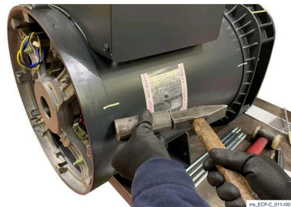
6) Enlevez l'extrémité non motrice à l'aide d'un marteau et d'une barre en aluminium ou en cuivre.
