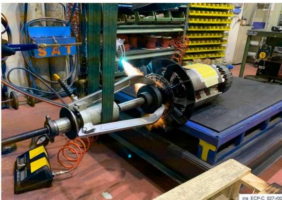
2) Chauffez le moyeu avec un chalumeau oxyacétylénique, tout en continuant à tirer l'extracteur jusqu'à l'extraction complète du moyeu.
