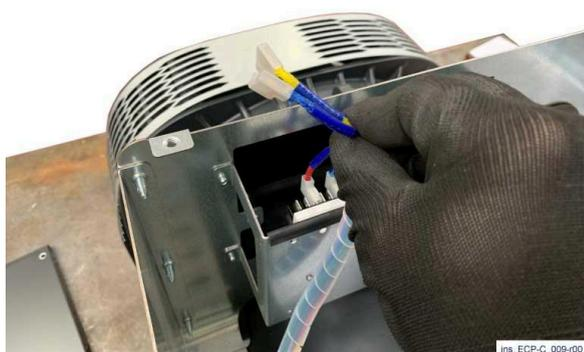
2) Coupez le collier de serrage des fils du régulateur, retirez le câble jaune et bleu du régulateur et faites-le passer à travers son orifice dans le châssis.
