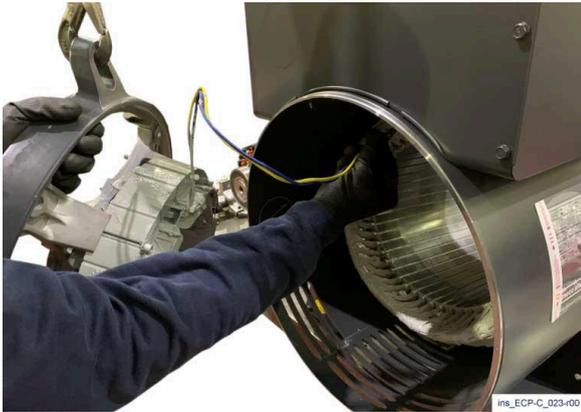
6) Attachez le support de l'extrémité non motrice à un système de levage approprié, réinsérez les fils jaunes et bleus dans l'orifice approprié dans le châssis, puis insérez le support de l'extrémité non motrice à sa place.
