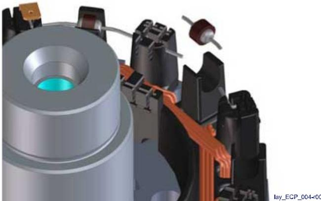
Lorsque les valeurs mesurées indiquent une diode endommagée, il faut la remplacer. Pour ce faire, il est recommandé de ne pas retirer les rhéophores de leur emplacement, mais de les couper le plus près possible du corps du composant, puis d'insérer le nouveau composant en respectant la polarité et de souder soigneusement les rhéophores avec les pièces restées à leur emplacement.
