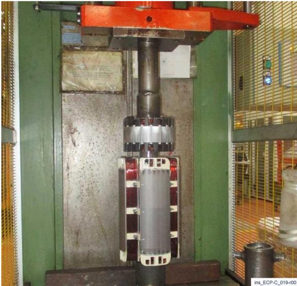
2) À l'aide d'une presse, insérez un nouveau stator de l'excitatrice sur l'arbre. Il est également possible de le chauffer à 110 °C maximum et de le pousser jusqu'à l'épaule de l'arbre. Faites passer les fils du rotor principal à travers l'orifice du rotor de l'excitatrice et fixez-le dans le pont de diodes en respectant la polarité.
