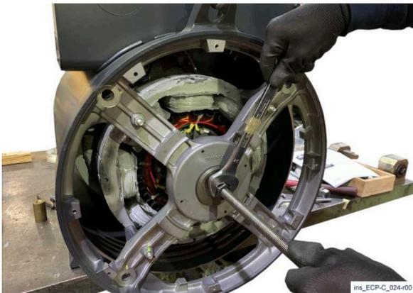
7) Vissez une barre fileté dans l'orifice fileté de l'arbre et vissez un écrou, en interposant une bride adaptée entre l'écrou et le support de l'extrémité non motrice. Vissez l'écrou jusqu'à ce que le palier atteigne l'épaulement du support de l'extrémité non motrice.
