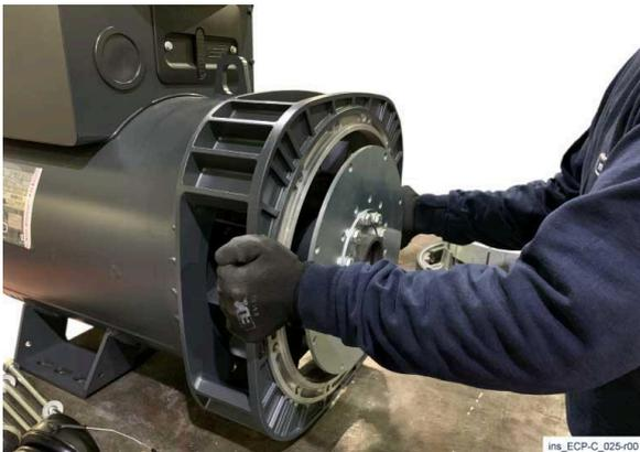
8) Insérez le support de l'extrémité motrice en respectant les inscriptions faites précédemment, puis insérez les goujons de sécurité de la protection. Enfin, branchez le câble bleu et jaune sur le régulateur dans la même position que précédemment et fixez-le à l'aide d'un collier de serrage. Fixez ensuite la grille arrière et la protection de la boîte de jonction.
