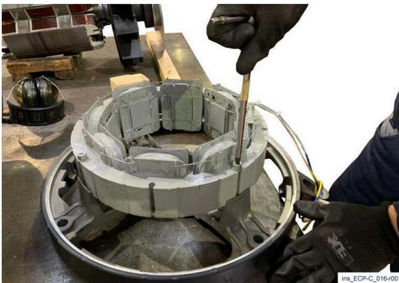
10) Retire los tornillos de fijación del estator del excitador.
