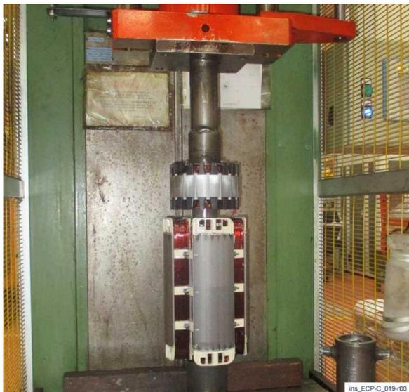
2) Con una prensa, inserte un nuevo rotor excitador. Alternativamente, se puede calentar a 110 ° C y empujar hasta que llegue al tope. Luego pase los cables del rotor principal a través del orificio del rotor del excitador y luego fíjelos al puente de diodos respetando la polaridad correcta.
