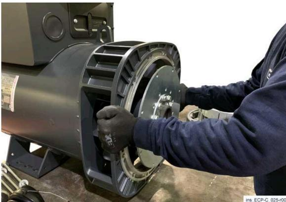
8) Vuelva a insertar la cubierta frontal. Haga coincidir las marcas previamente hechas entre la cubierta y la carcasa, luego atornille nuevamente las varillas de unión. Vuelva a cablear los cables amarillo y azul en el regulador y luego asegúrelos con bridas. Finalmente, vuelva a armar la parrilla trasera y la tapa de la caja de terminales.
