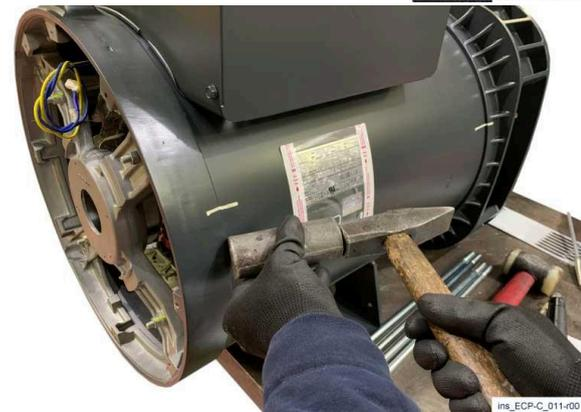
6) Retire la cubierta posterior con la ayuda de un martillo y una varilla de cobre o aluminio.
