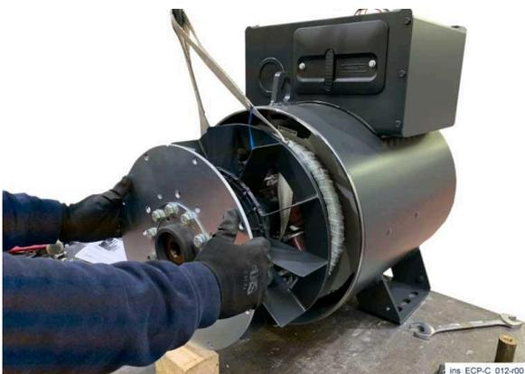
7) Extraiga el rotor tirando de él manualmente. Al hacer esto, coloque bloques de madera de grosor adecuado debajo de los discos para soportar el rotor.
