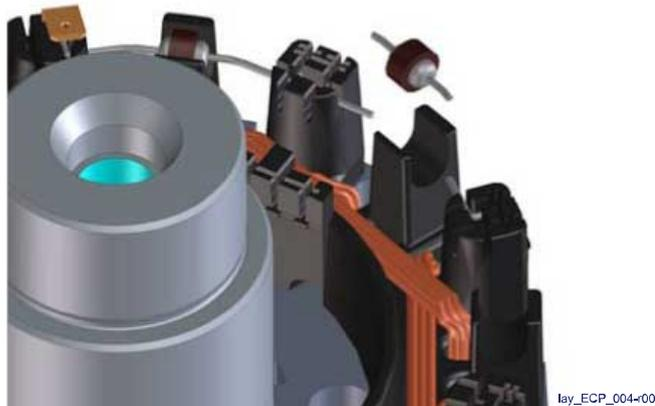
Si los valores encontrados indican un diodo dañado, el componente debe ser reemplazado. Para este propósito, se recomienda no extraer los cables de sus respectivos asientos, sino cortarlos cerca del cuerpo del componente; inserte el nuevo componente respetando las polaridades y suelde cuidadosamente los cables con las piezas que quedan en sus asientos.
