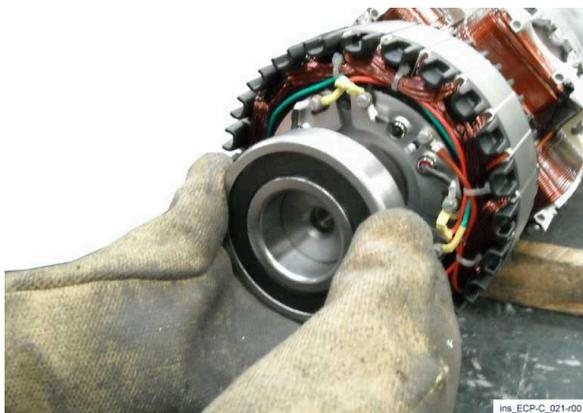
4) Usando guantes antiescalda apropiados, empújelo sobre el eje hasta que llegue al tope. Espere a que el rodamiento se enfríe antes de proceder con el reensamblaje de la máquina.
