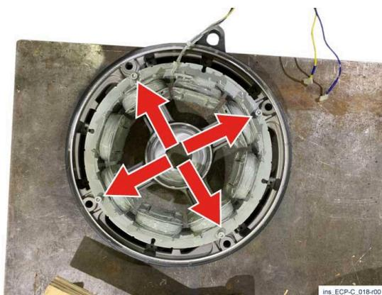
1) Coloque un nuevo estator excitador en los pies de la cubierta posterior con los cables amarillo-azul colocados correctamente hacia la parte superior de la cubierta (vea la imagen al costado), luego empuje el estator en contacto con la ayuda de un martillo de goma. Inserte los tornillos y apriételes como 9.6.
