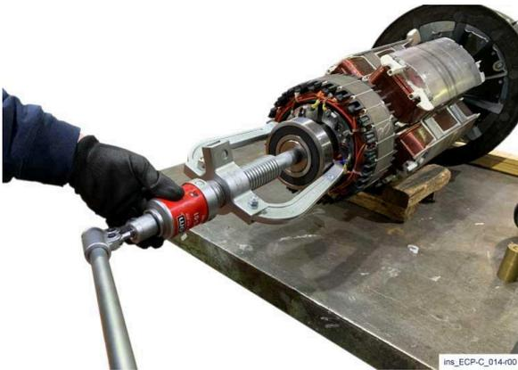
9) Con un extractor adecuado, retire el rodamiento del eje. Desconecte los dos cables que provienen del rotor principal del rotor del excitador, retirándolos del rotor del excitador. Retire el rotor del excitador con un extractor normal.
