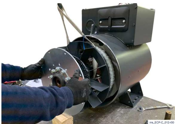
7) Estrarre il rotore, tirandolo manualmente. Nell'eseguire questa operazione, posizionare dei blocchi in legno di spessore adeguato sotto ai dischi, per sostenere il rotore.
