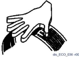
Nelle fasi di montaggio e smontaggio della rete, assicurarsi di tenere in posizione con le mani la stessa per evitare che l'elasticità della rete possa colpire l'operatore o chi è nelle vicinanze.
