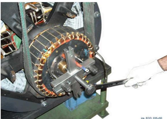
Assicurare il rotore eccitatrice ad un adeguato dispositivo di sollevamento utilizzando una cinghia morbida.
