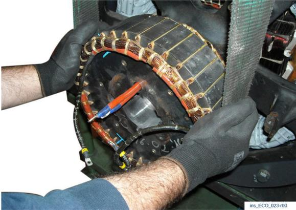
Con un adeguato sistema di sollevamento e con l'ausilio di una cinghia morbida, sollevare il rotore eccitatrice. Inserire il rotore nell'albero, nella posizione originale. Prestare molta attenzione alla posizione della chiavetta segnata in fase di smontaggio.
