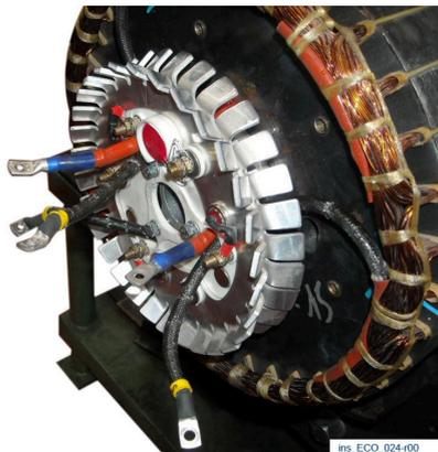
Inserire il ponte diodi rotante e avvitare le 3 viti M5 a 3.3 Nm.
