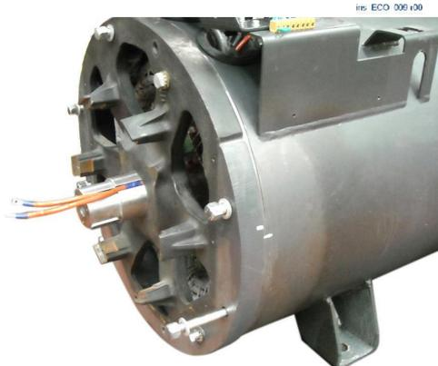
Con un pennarello, segnare la posizione dei coperchi anteriore e posteriore rispetto alla carcassa per permettere un loro corretto rimontaggio.
