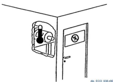
**i** Installare l'alternatore in ambiente aerato. Un'aerazione insufficiente può causare surriscaldamento e malfunzionamento dell'alternatore.
