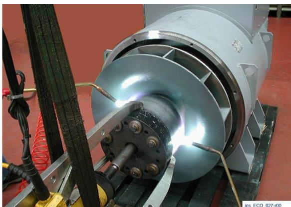
Chauffez le moyeu de support de disque. Utilisez deux chalumeaux oxyacétyléniques.
