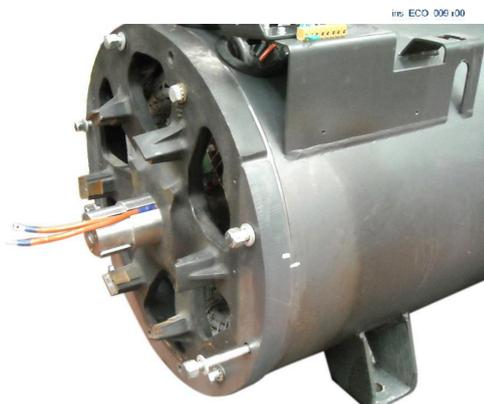
Utilisez un feutre pour marquer la position des protections avant et arrière par rapport au châssis afin de permettre un remontage correct.
