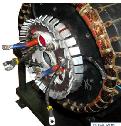
Insérez le pont de diodes rotatif et vissez les 3 vis M5 à 3,3 Nm. Rebranchez les trois câbles du rotor de l'excitatrice et les deux câbles du rotor principal dans leur configuration initiale.
