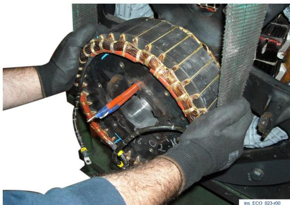
En utilisant un système de levage approprié et une courroie souple, soulevez le rotor de l'excitatrice. Introduisez le rotor dans l'arbre, dans sa position initiale. Respectez soigneusement la position de la clavette marquée pendant l'étape de montage.
