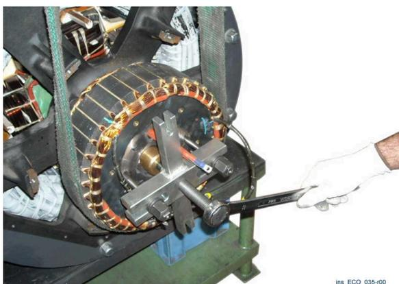
Fixez le stator de l'excitatrice sur un dispositif de levage approprié en utilisant une courroie souple. Enlevez-le à l'aide de l'extracteur Mecc Alte approprié.
