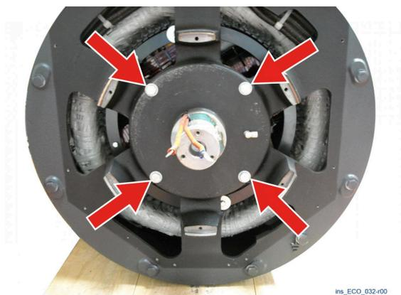
Avant de démonter le couvercle arrière, retirer les quatre boulons de fixation de la petite flasque.
