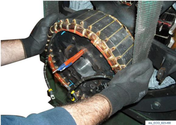
Heben Sie den Erreger-Rotor mit einem geeigneten Hebezeug und einem weichen Gurt an. Führen Sie den Rotor an seine ursprüngliche Position in die Welle ein. Beachten Sie dabei die während der Montage markierte Position des Schlüssels.
