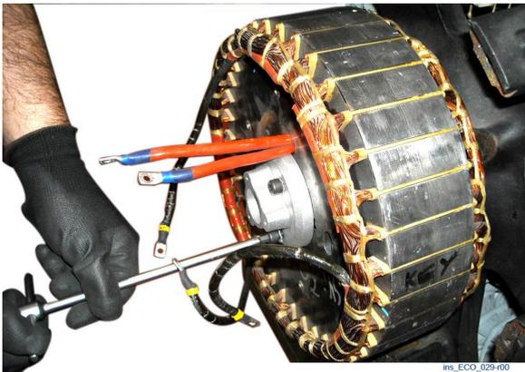
Die sechs M8-Schrauben mit 25 Nm anziehen, um die Blockiernabe des Erregerrotors zu befestigen.
