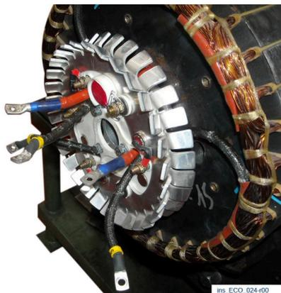
Führen Sie die drehbare Diodenbrücke ein und schrauben Sie die 3 M5-Schrauben mit 3,3 Nm an. Verkabeln Sie die drei Kabel des Erreger-Rotors und die zwei Kabel des Hauptrotors neu gemäß ihrer ursprünglichen Konfiguration
