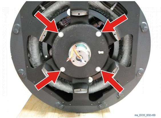
Bevor Sie die hintere Abdeckung demontieren, entfernen Sie die vier Befestigungsschrauben der Zapfenverbindung. Bei der 43-Serie ist ein zusätzlicher Schmiermittelschutzring vorhanden. Achten Sie bei der erneuten Montage genau darauf, ihn richtig zu zentrieren.
