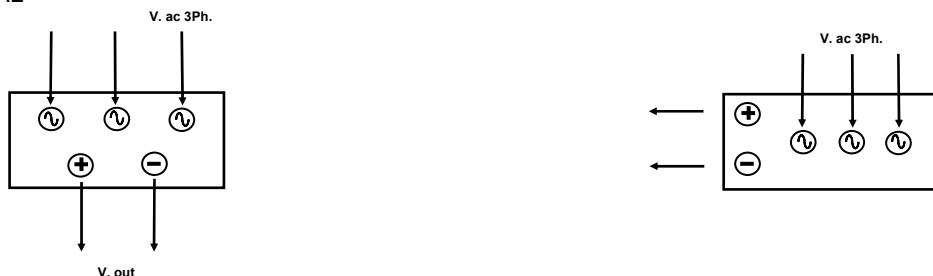
COLLEGAMENTO PONTE RADDRIZZATORE MULTIPLO - MULTIPLE RECTIFIER BRIDGE CONNECTION - CONNEXION DE PONT MULTIPLE REDRESSEUR - VERBINDUNG MIT MEHREREN GLEICHRICHTER-BRÜCKEN - CONEXION DE PUENTE RECTIFICADOR MULTIPLE
