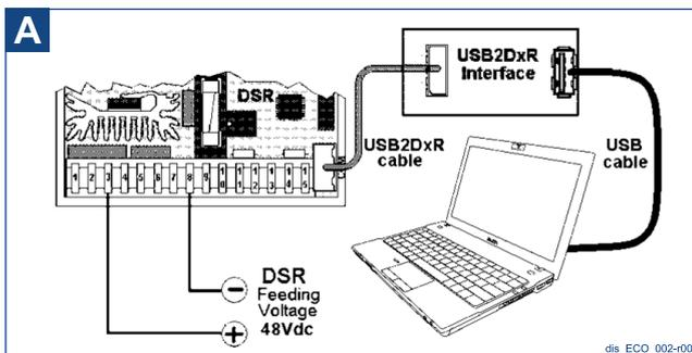
Alimentazione DSR 48Vdc per il download degli allarmi senza rischiare di modificare il contenuto della EEPROM a causa dei test.
