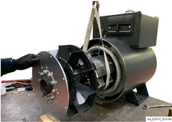
8) Appena possibile, posizionare una cinghia morbida attorno al pacco rotore, quindi continuando ad estrarre il rotore, spostare la fune fino a trovare il punto di equilibrio. Sollevare poi il rotore e posizionarlo in un luogo sicuro.
