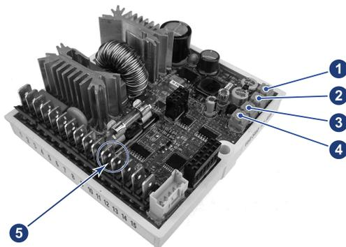
1. Regolazione protezione di sovraccarico (AMP).
