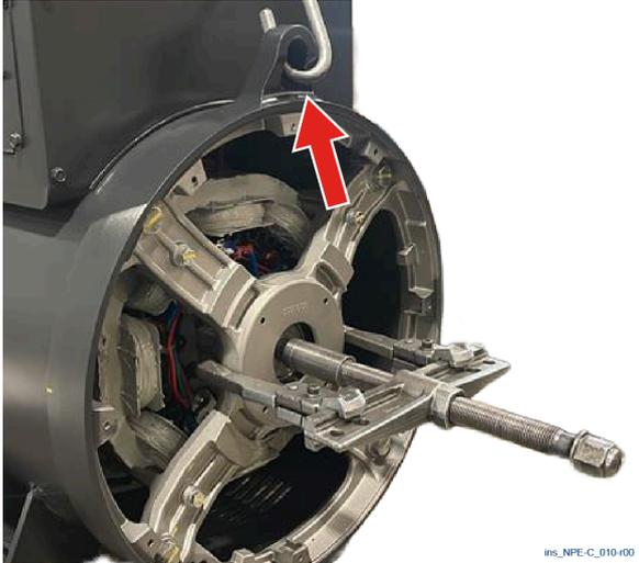
5) Inserire una vite nel foro posteriore dell'albero e, utilizzando un estrattore, spingere l'albero fino a che il cuscinetto non sia uscito completamente dalla sede nel coperchio posteriore.
