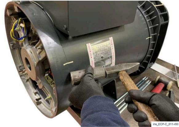
6) Dopo aver svitato le viti di fissaggio del coperchio posteriore, procedere a togliere il coperchio posteriore con l'aiuto di un martello e un tondo in rame o alluminio.
