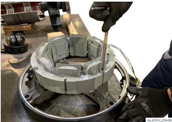
10) Rimuovere le viti di fissaggio dello statore eccitatrice.
