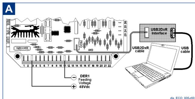
Alimentazione DER1 48Vdc per il download degli allarmi senza rischiare di modificare il contenuto della EEPROM a causa del test.
