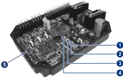
1. Regolazione della protezione di sovraccarico (AMP).
