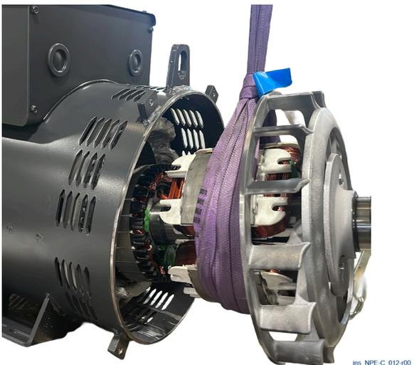
7) Estrarre il rotore, tirandolo manualmente. Nell'eseguire questa operazione, posizionare dei blocchi in legno di spessore adeguato sotto ai dischi, per sostenere il rotore.
