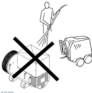
**i** É vietato assolutamente l'uso di qualsiasi tipo di idropulitrice e di liquidi detergenti in prossimità dell'alternatore. Il grado di protezione standard dell'alternatore è IP23 e pertanto utilizzando liquidi potrebbero verificarsi delle anomalie o anche cortocircuiti.
