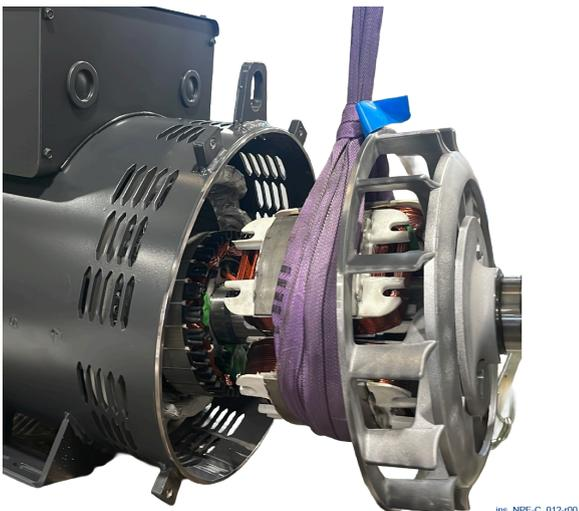
7) Extraiga el rotor tirando de él manualmente. Al hacer esto, coloque bloques de madera de grosor adecuado debajo de los discos para soportar el rotor.
