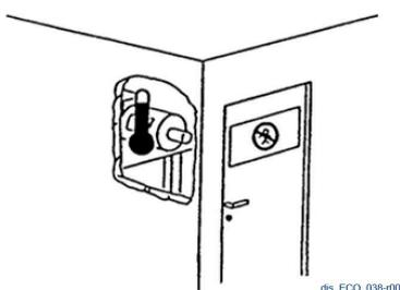
**i** Instalar el generador en un ambiente ventilado. Una ventilación insuficiente puede causar el sobrecalentamiento y mal funcionamiento del alternador.
