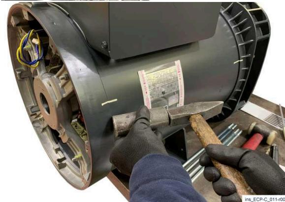
6) Tras desenroscar los tornillos de fijación del coperchio posterior, retirar dicho coperchio con ayuda de un martillo y un cilindro de cobre o aluminio.
