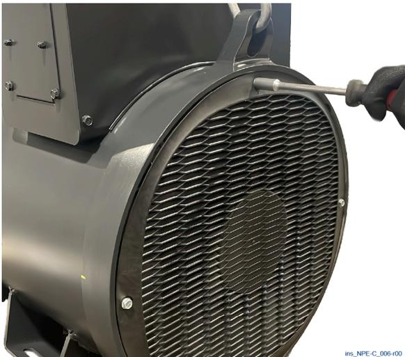
1) Retire la cubierta de la caja de terminales y la parrilla trasera.
