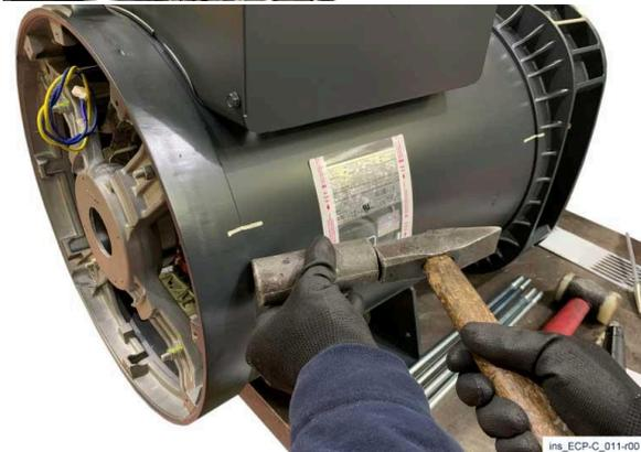
6. Nach dem Entfernen der Schrauben des hinteren bracket, diesen mit Hammer und Kupfer- oder Aluminiumrundstab lösen.
