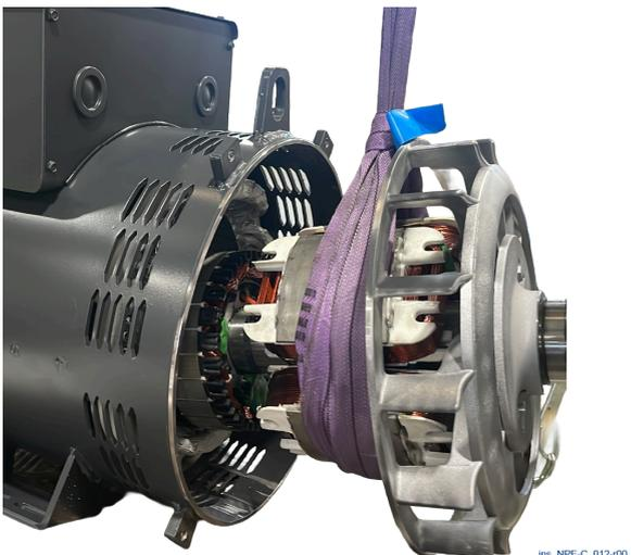
7) Ziehen Sie den Rotor manuell heraus. Positionieren Sie während dieses Vorgangs Holzblöcke unter den Scheiben um den Rotor zu halten.
