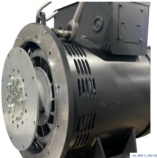
3. Befestigungsschrauben des vorderen bracket entfernen.
