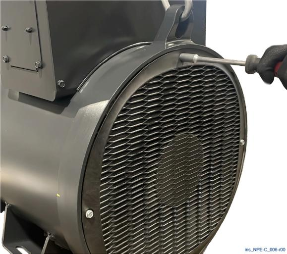
1) Entfernen Sie den Deckel des Klemmenkastens und das hintere Gitter.
