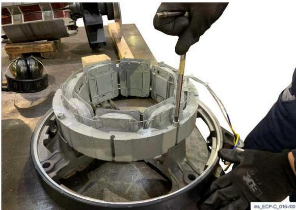
11) Entfernen Sie die drei Schrauben des Erregerstators.
