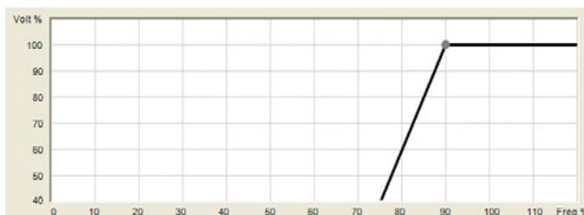
Fig. 9.2-B : Connexion V/f avec P[64]=0,1 et P[66]=3,9957
