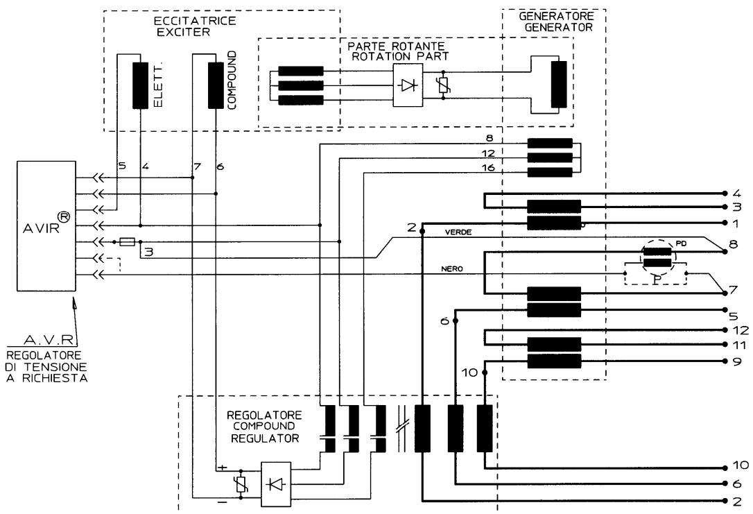
Il dispositivo di parallelo PD è opzionale. Il ponticello P abilita o disabilita il dispositivo se presente.
