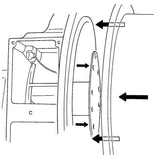
e) allineare uno dei fori di fissaggio dei dischi del volano con il foro dei dischi precedentemente posizionato (punto "c")
