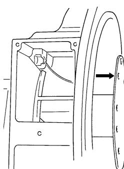
d) avvicinare l'alternatore al motore di accoppiamento
