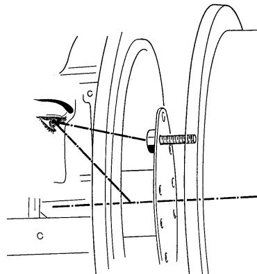
h) terminata l'operazione di bloccaggio dischi, ribloccare la ventola serrando la relativa vite con una coppia di serraggio pari a  $12 \text{ Nm} \pm 10\%$ ; la posizione radiale della ventola non è vincolante per il corretto funzionamento del sistema
