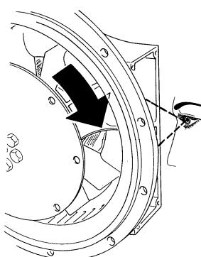
b) rendere la ventola libera di ruotare allentando la vite M8 di bloccaggio, utilizzando una chiave esagonale possibilmente con testa snodata
