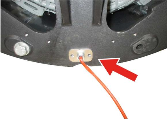
Retire la goma protectora e inserte el calentador en el orificio.
