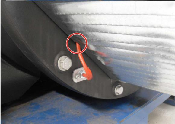
Identifique los orificios en la abrazadera de cable de nylon 3.5x140 como se muestra en la figura.
