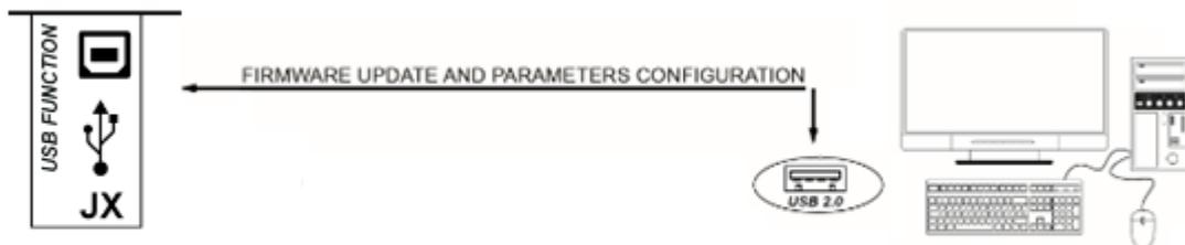
GC250 è dotato di una porta USB con connettore di tipo B per la connessione temporanea ad un PC per la configurazione dei parametri o il download degli archivi storici.
